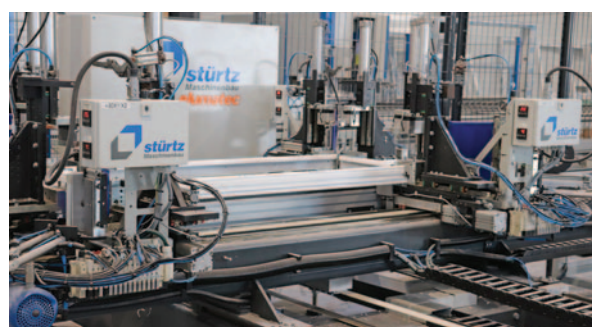
Acquise en 2020, la soudeuse ébavureuse quatre têtes permet de traiter un châssis en 2 minutes, au lieu de 4 minutes pour le modèle acheté il y a quatre ans.
