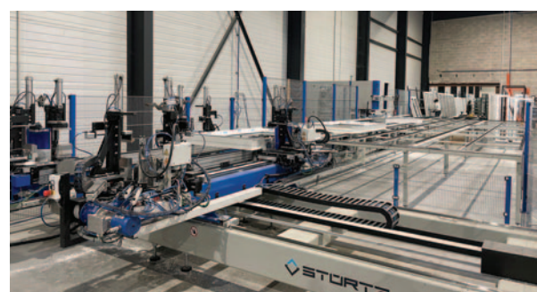
Acquise en 2020, la soudeuse ébavureuse quatre têtes permet de traiter un châssis en 2 minutes, au lieu de 4 minutes pour le modèle acheté il y a quatre ans.
