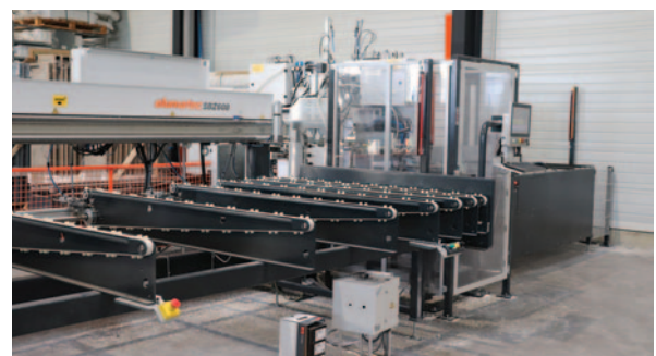
Moins rapide, l'autre centre Elumatec usine les dormants.
