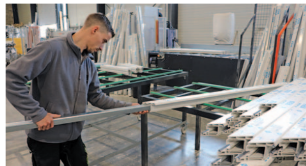
Pose de renforts métalliques dans certaines pièces.
