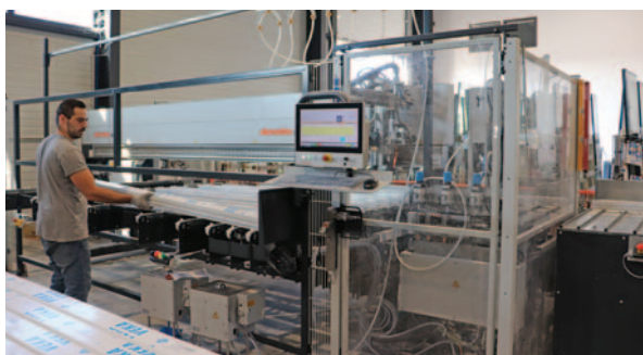
Deux centres réalisent le perçage des trous de poignées, de battues et le vissage des renforts. Celui-ci, plutôt destiné aux ouvrants, réalise le vissage en amont.
